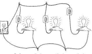
5 ohms + 5 ohms + 10 ohms = 2 ohms
