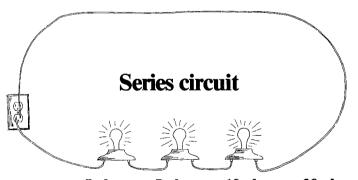
5 ohms + 5 ohms + 10 ohms = 20 ohms
